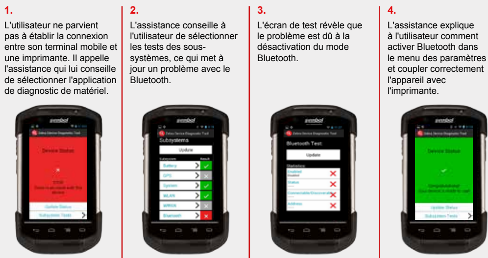
FIG. 3 : EXEMPLE DE FLUX DE TRIAGE ET DE RÉOLUTION UTILISANT LE SERVICE DE DIAGNOSTIC DE MATÉRIEL
